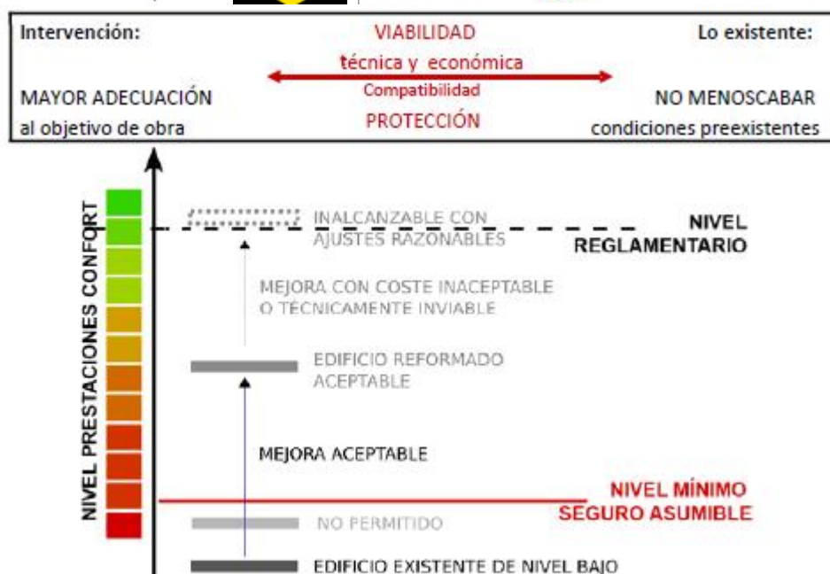
Figura 2.- Concepto de mejora de la edificación existente
